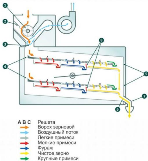
Сырье поступает на подающий ролик **1** и подающую каретку **2**. На данном этапе сырье дозируется и поступает в aspiraционный канал **3**, где пропускается через поток воздуха.
